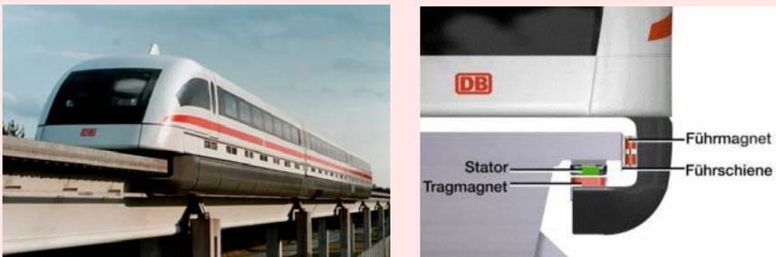
Ähnlich schweben Magnetschwebbahnen wie der Transrapid. Sie erreichen Geschwindigkeiten von über 500 km/h.
