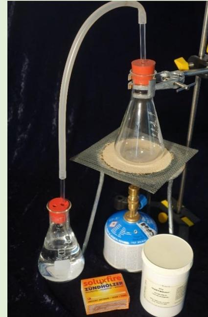
Erhitzt du Kaliumpermanganat, so entsteht Gas und zwei Manganverbindungen. Dies zeigt, dass eine chemische Reaktion stattgefunden hat.
