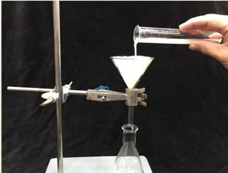
(7) Wenn du alles in den Filter gegossen hast, gib mit Hilfe der Spritzflasche Wasser an den Rand des Reagenzglas, um noch vorhandene Kreidereste abzuspülen. Gieße auch die Reste in den Trichter.
