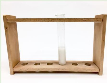
Bei den Experimenten 5 und 6 hast du eine Suspension hergestellt - eine Kreide-Wasser-Suspension.
